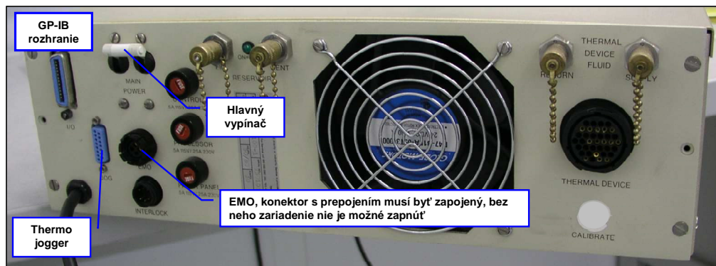
Obr. 9. zadný panel Temptronic kontroléra v zapnutom stave
