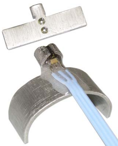
Obr. 8. Mechanická konštrukcia teplotných senzorov
