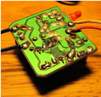
Obr.4. Spodná strana PCB nabíjačky (po úprave napäťového deliča)
